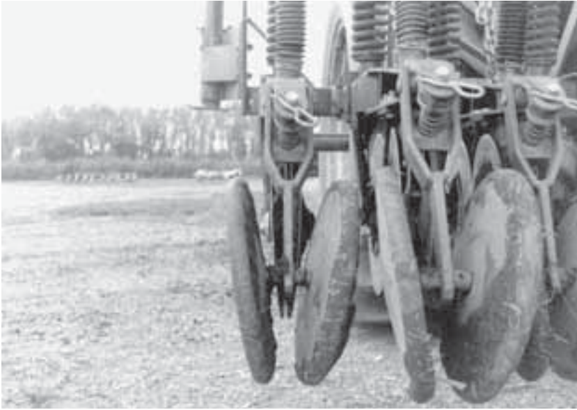
Lámina 6 Ruedas compresoras colocadas en una configuración en V para cerrar las ranuras en labranza cero creadas por los abresurcos verticales de doble disco (de Baker, 1981a, b).
