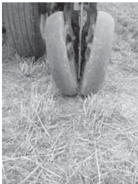
Lámina 27 Reposición casi completa de los residuos sobre la ranura creada por la versión con disco de un abresurco en forma de T invertida (cobertura clase IV).
