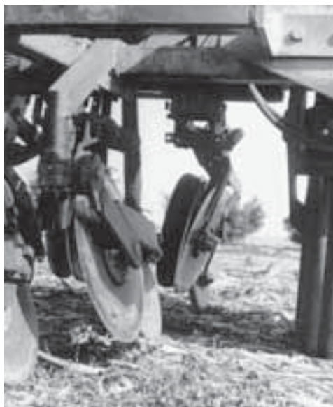
Lámina 7 Un par de discos inclinados en ángulos opuestos. Los discos delanteros colocan el fertilizante y los discos traseros colocan las semillas a menor profundidad (de Baker et al. , 1996).
