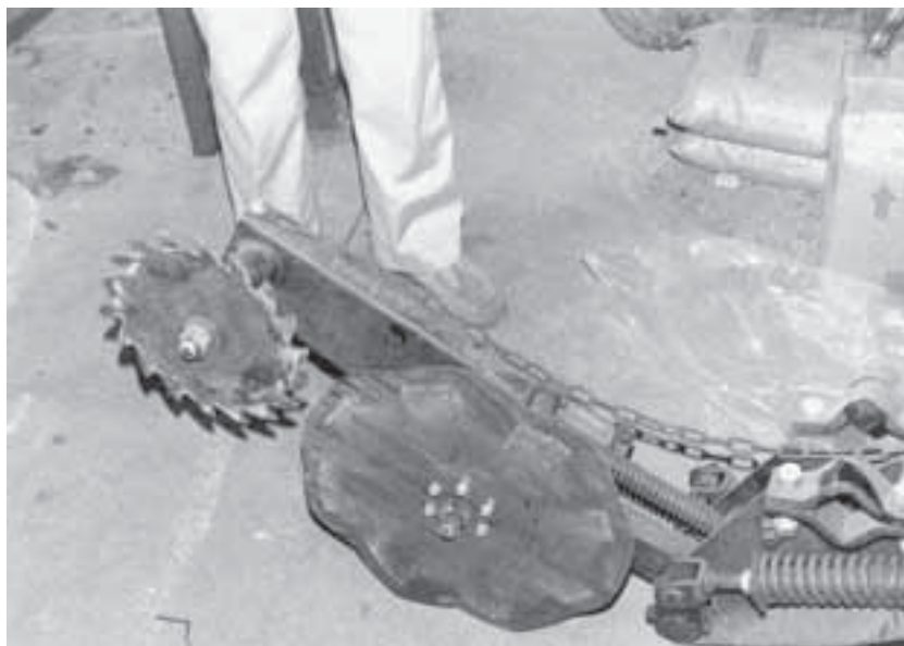
Lámina 18 Abresurcos para labranza cero movido por la toma de fuerza por medio de un disco dentado (de Baker et al. , 1996).
