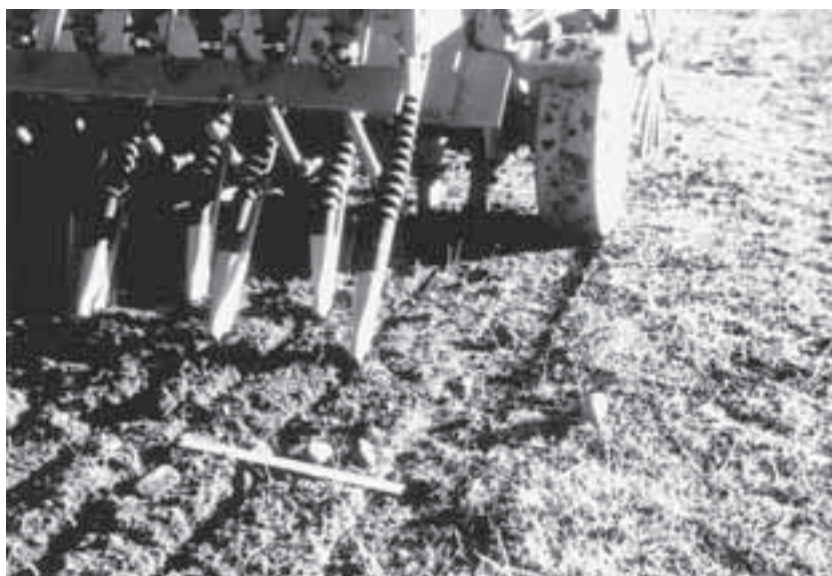
Lámina 15 Fajas angostas labradas por un abresurcos movido por toma de fuerza para labranza cero (de Baker et al. , 1996).
