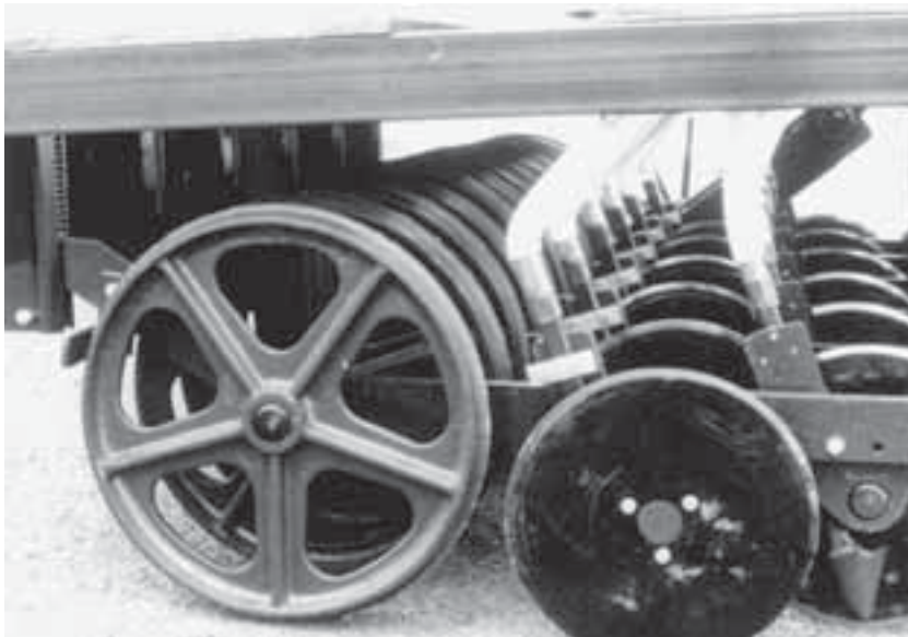
Lámina 8 Un par de abresurcos de discos planos angulados para labranza cero (de Baker et al. , 1996).
