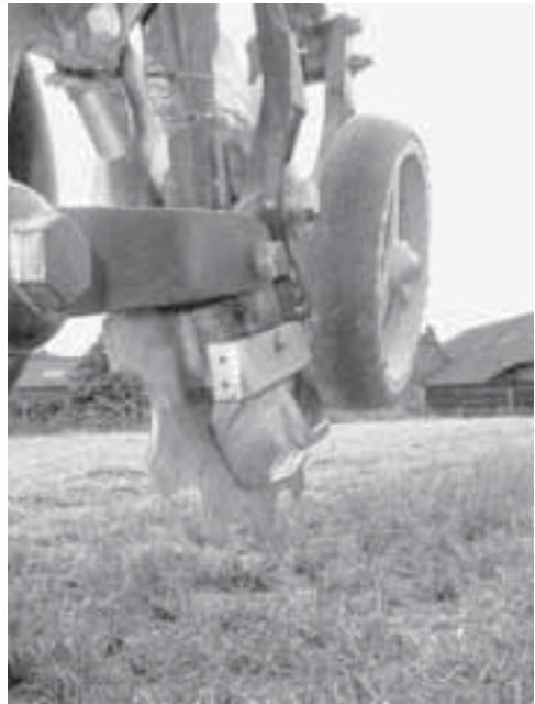
Lámina 25 Una versión de discos del abresurco de ala para crear ranuras en T invertida.
